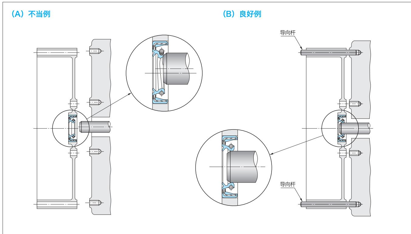
注: (A) 中, 由于手持安装重腔体难以使轴与油封同心, 因此轴会碰到唇口部而变形。为此, 请如(B)所示, 利用安装腔体的螺栓孔, 设置导向杆。
