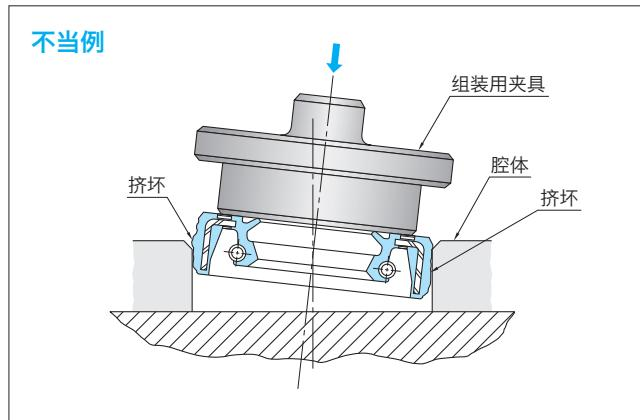
④配合部分为橡胶油封时,为了毫无浮起地安装于正确位置,请反复加压两次。
