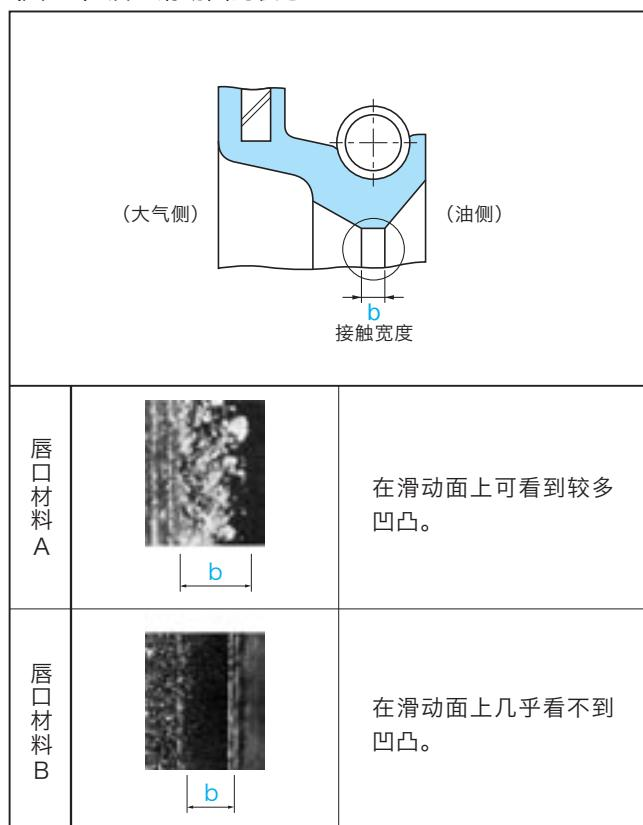
使用这两种唇口材料，在相同接触压力分布下，制造了油封。
