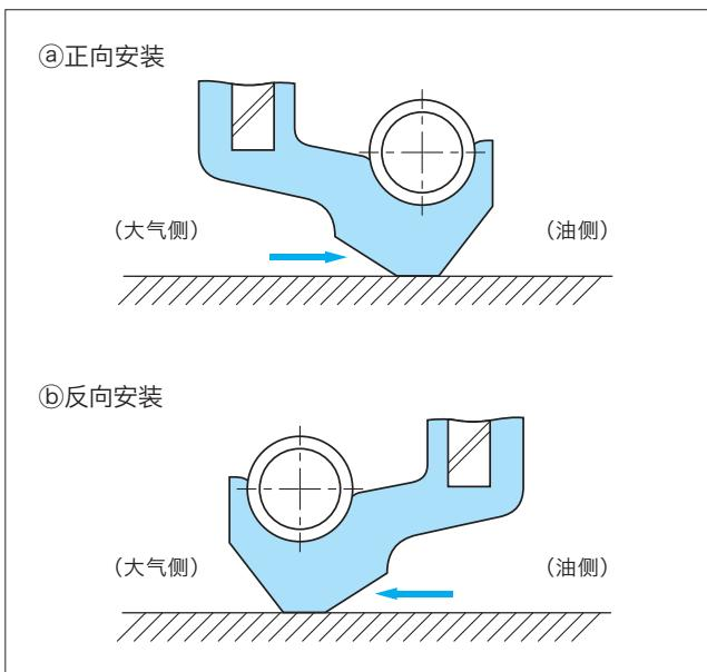
⑤中，通过测量油向大气侧泄漏的单位时间的平均泄漏量（相当于正向安装时的流体送入量），可以定量地掌握油封具有密封功能的一部分。
