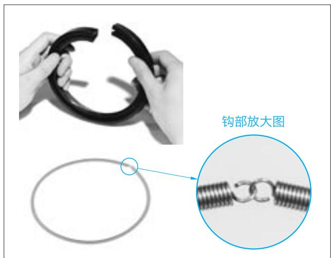
〈图-20.〉 MG型油封的切断方法
