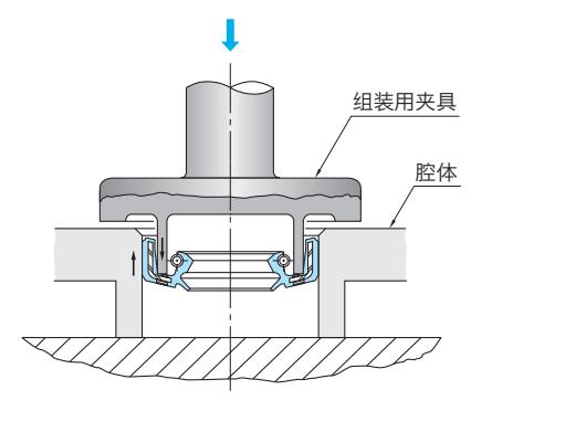
③组装时,请将油封水平放置在腔体孔上均匀加压。若在油封倾斜状态下强制压入,则会如**〈图-7.〉**所示,油封的配合部分被挤坏或被卡住,导致泄漏。
